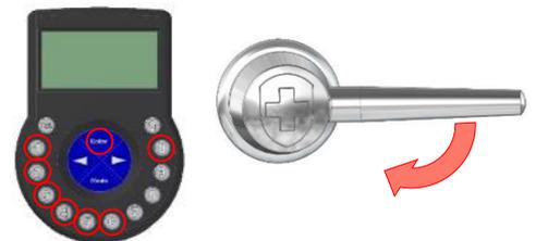
3. Türe öffnen. Die offene Türe wird, über die Eingabeeinheit, alle 30 Sekunden mit einem kurzen akustischen 6x-Signal bestätigt, bis die Türe wieder geschlossen wird.
