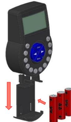
4. Batteriefach wieder vorsichtig nach oben ins Gehäuse schieben und mit der Senkschraube (Inbus 2mm) festschrauben.
