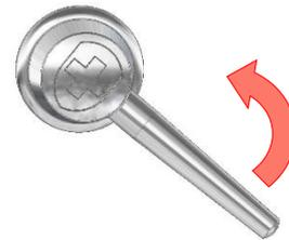
3. Durch Drücken des Öffnungsdrehgriffes im Uhrzeigersinn überprüfen, ob das Schloss und somit der Tresor verschlossen ist.
