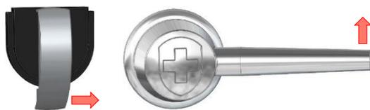
2. Tastatur an der oben angebrachten Lasche vorsichtig aus der Eingabeeinheit lösen und nach unten klappen.
